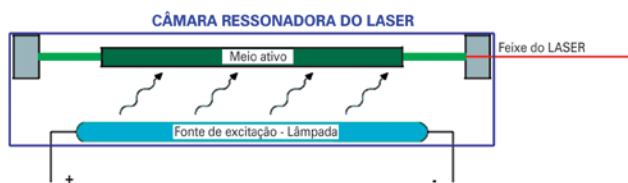
Figura 1. Funcionamento da câmara ressonadora.
